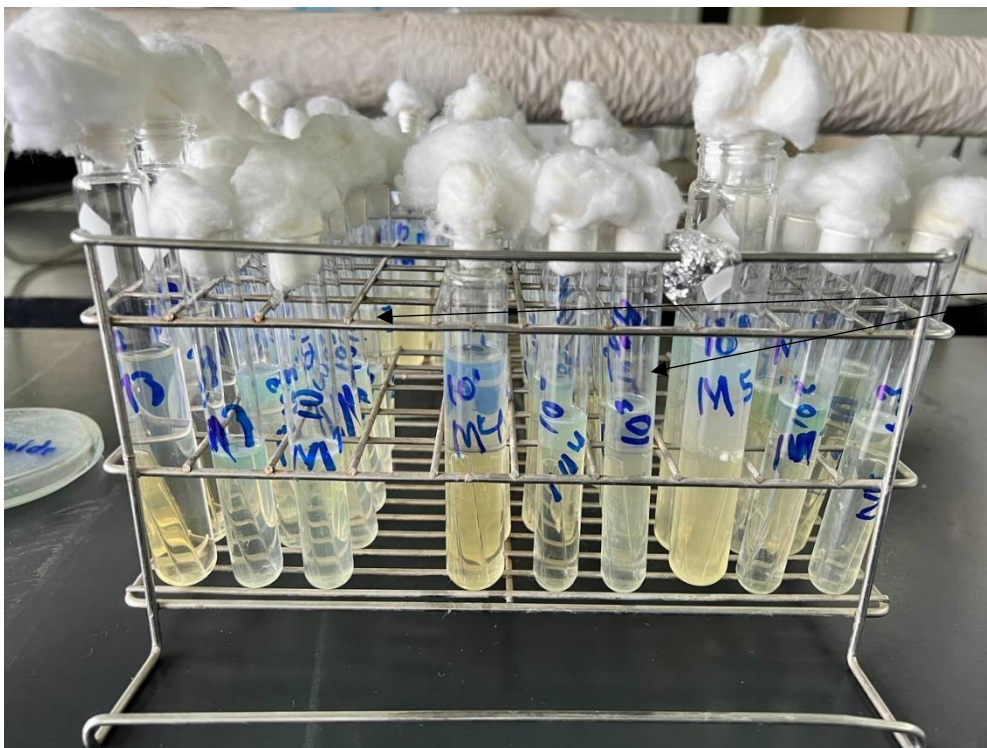
Imagen N° 5. Prueba presuntiva de coliformes totales
