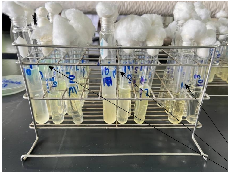
Imagen N° 3. Prueba presuntiva de coliformes totales
