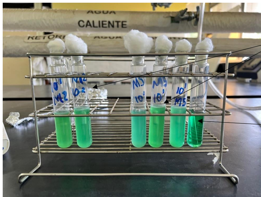
Imagen N° 19. Prueba confirmativa de coliformes totales
