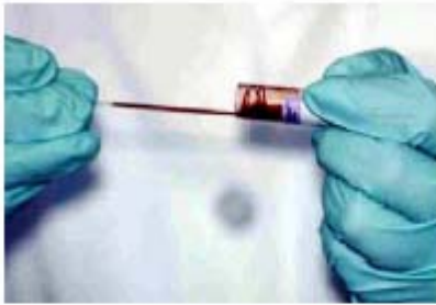
Fig. 41. Llenado del tubo capilar.
