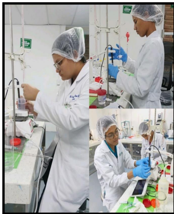
Figura 14. Lectura de las muestras mediante el método potenciométrico de nitrato de lantano.
