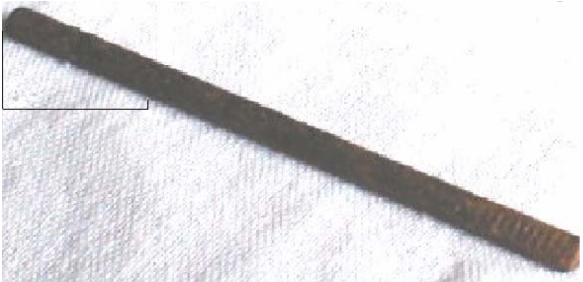
Figura No 8. Foto del hierro después de estar inmerso en el agua de mar durante 5 horas. En la foto las líneas indica la superficie que fue expuesta al medio de experimentación.
