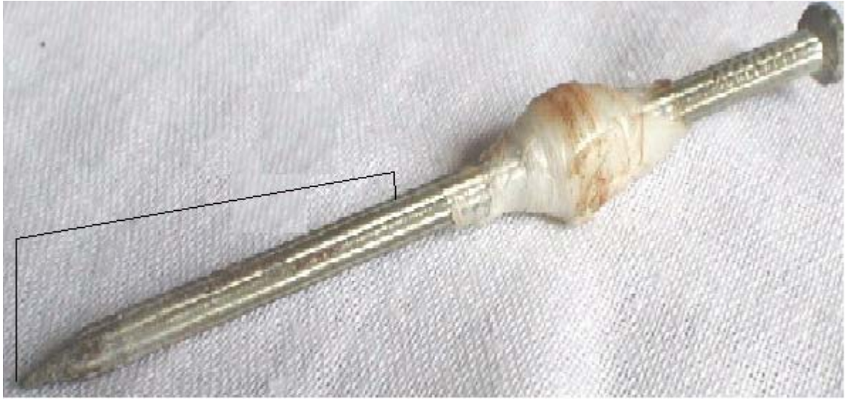
Figura No11. Foto del acero que fue expuesto a la solución de NaCl al 2..5% durante 5 horas.
