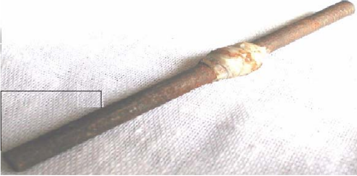
Figura No 7. Foto del hierro que fue sumergido en solución de sal de mesa al 2.5 % durante 5 horas. En la foto las líneas indica la superficie que fue expuesta al medio de experimentación
