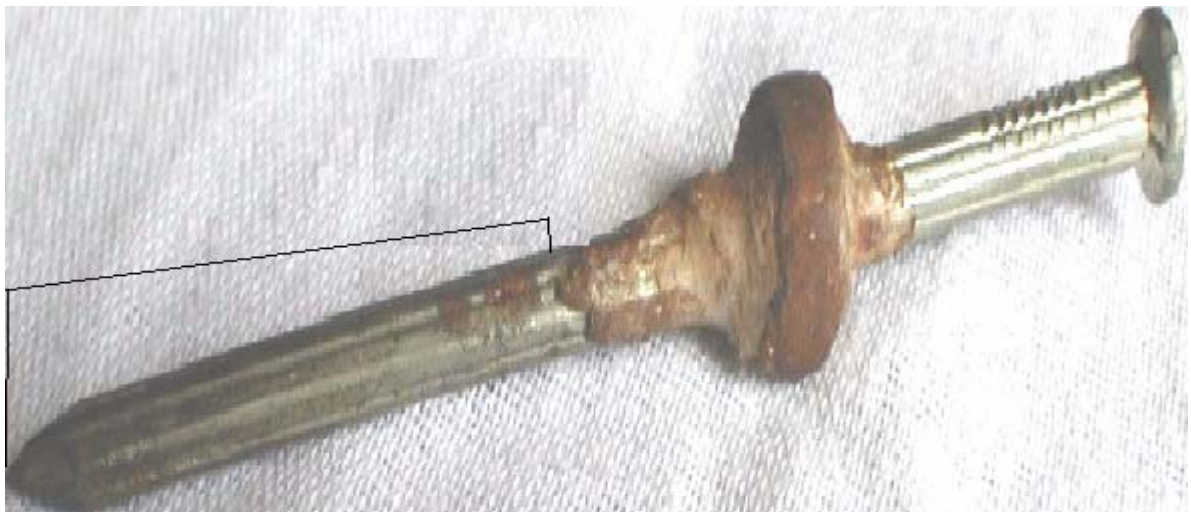
Figura No 12. Foto del acero previamente sumergido en solución de salmuera al 2.5% durante 5 horas
