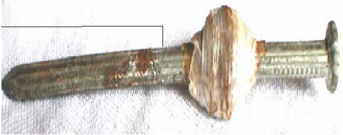
Figura No 13. Foto del acero previamente sumergido en agua de mar durante 5 horas.
