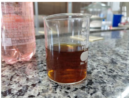
Figuras 21 y 22. Cambio de color obtenidos después de la síntesis de nanopartículas de plata a partir de extractos de hojas de naranja agria y limón respectivamente debido al fenómeno de superficie de plasmón de superficie.
