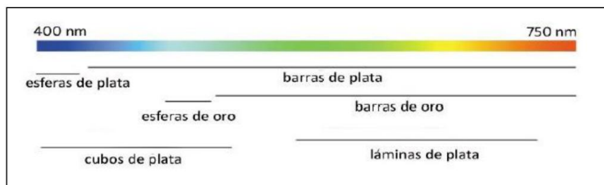
Figura 1. Clasificación de diferentes formas típicas de distintas nanopartículas metálicas y su localización con respecto al espectro UV-Vis según la absorción provocada por el SPR. (Moreno, 2017)
