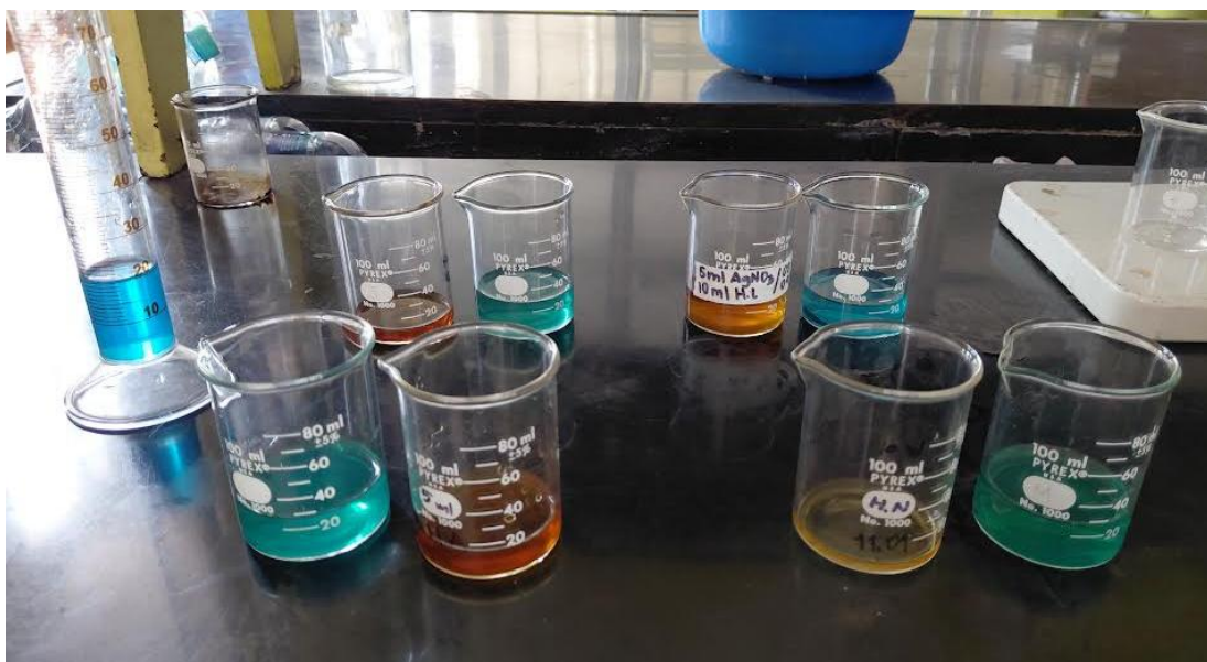
Figura 19. Ensayos de eficacia de las AgNPs obtenidas de extractos de hojas de limón y naranja agria. Observación de colores obtenidos en un lapso de tiempo de 90 minutos.
