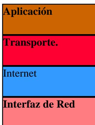
**Capa de Interfaz de red.** El software TCP/IP de nivel inferior consta de una capa de interfaz de red responsable de aceptar los datagramas IP y transmitirlos hacia una red específica. Una interfaz de red puede consistir en un dispositivo controlador (por ejemplo, cuando la red es una red de área local a la que las máquinas están conectadas directamente) o un complejo subsistema que utiliza un protocolo de enlace de datos propios.
