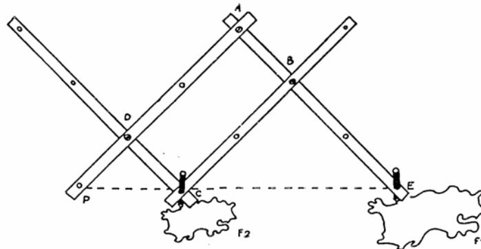
Comprueba que los triángulos DPC y APE siempre son semejantes, que los puntos P, C y E siempre están alineados y que cualquiera que sea el valor que tomen los ángulos del paralelogramo ABCD, al mover el pantógrafo  $PA : PD = PE : PC$ .
