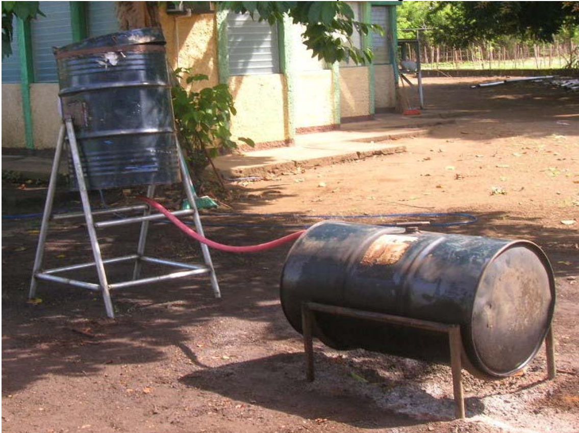
Anexo 4. Esterilizador Artesanal a base de vapor de agua
