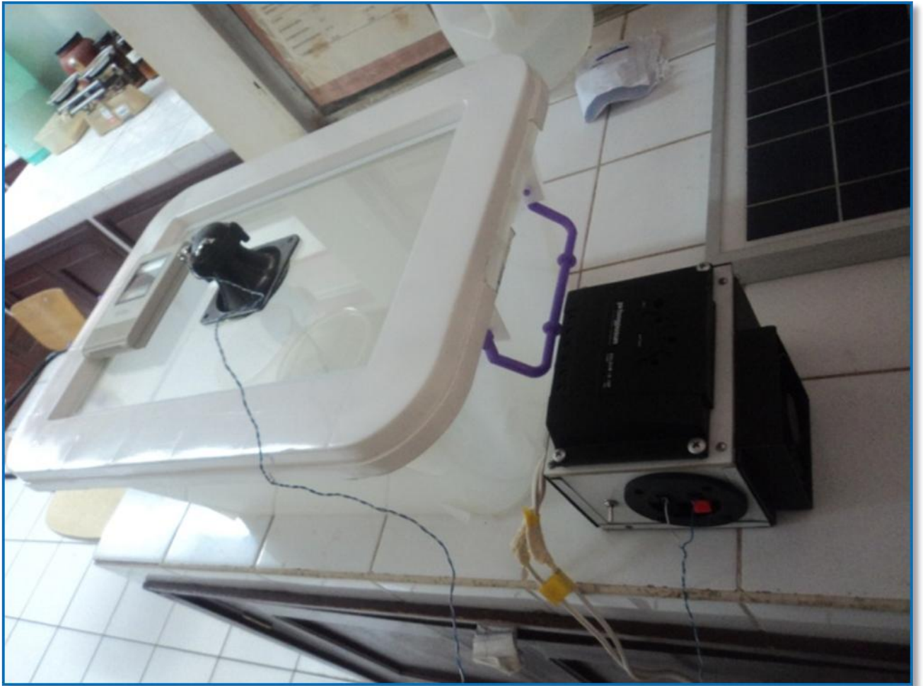
Foto 1. Aparato emisor de ondas ultrasónicas, utilizado para la irradiación en el insecto S. frugiperda .
