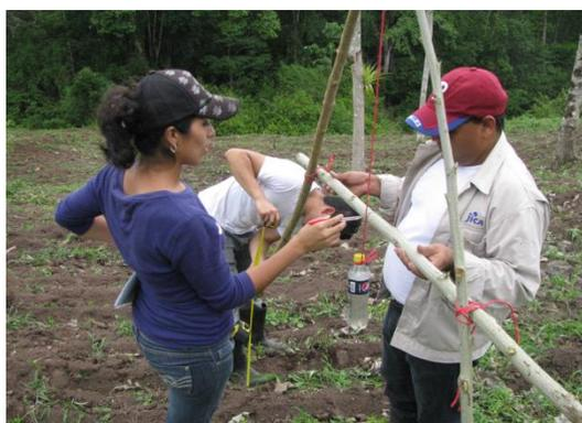
**Imagen 3.** Determinación de la pendiente con el aparato A.
