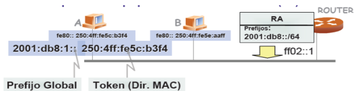
Figura 76: Configuración automática sin estado (II).
