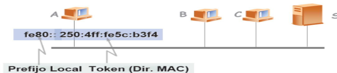
Figura 75: Configuración automática sin estado (I)
