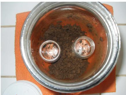
e) Colocación de un frasco de 20 ml de H<sub>2</sub>O y un frasco con 20 ml de NaOH
