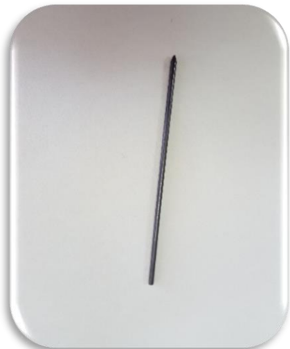
Foto 1. Mina de grafito para electrodo
