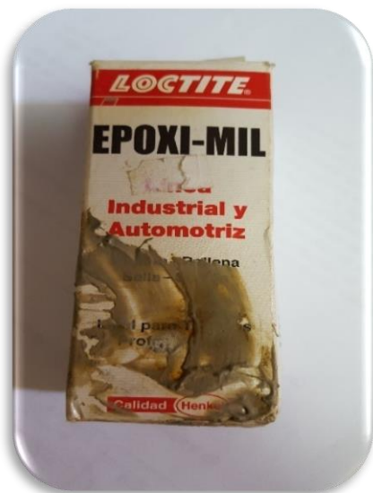
Foto 3. Resina EPOXI-MIL utilizada como sello
