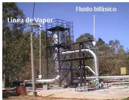
**Figura 7 Separador ciclónico instalado en un Campo Geotérmico**
