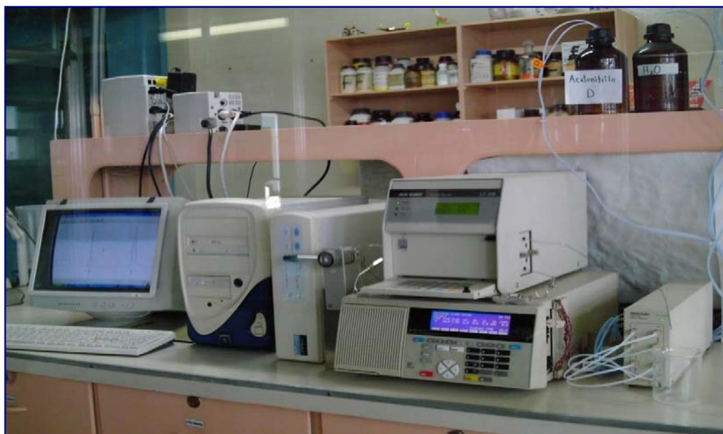
Fig. Equipo Cromatográfico utilizado para el análisis de  $\alpha$ -tocoferol.
