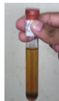
Fig. 46 Solución Glucosa 1% + Rx Fehling
