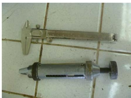
Durómetro y vernier
