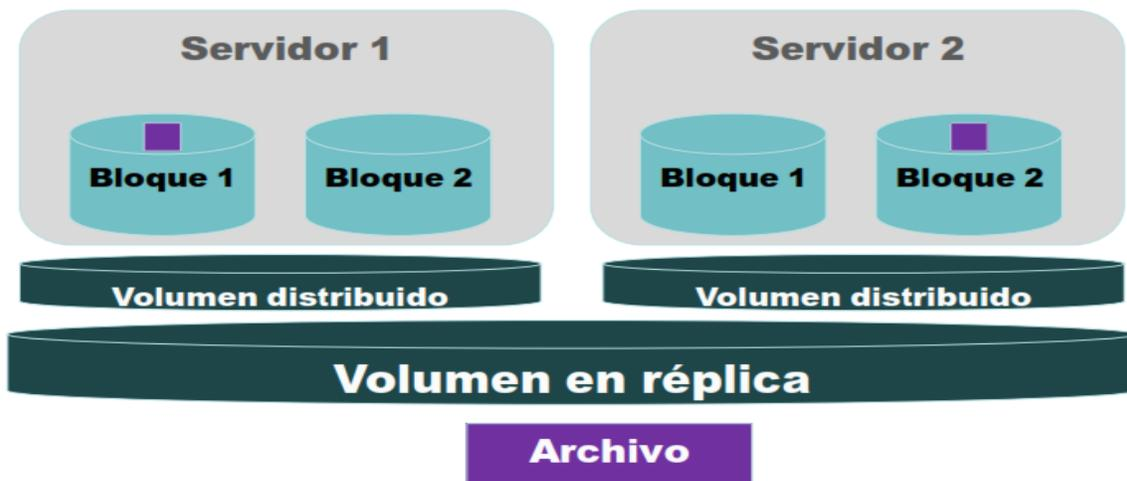
Figura 27 Distribución y Replicación de la data con: Distribuido en Réplica.
