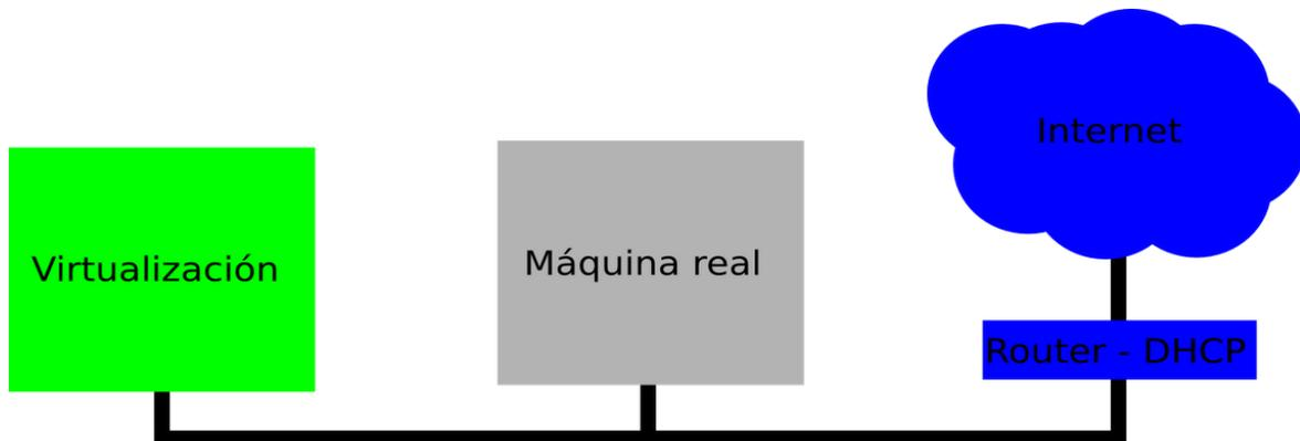
Figura 5 Ilustración de maquina en modo Bridge.
