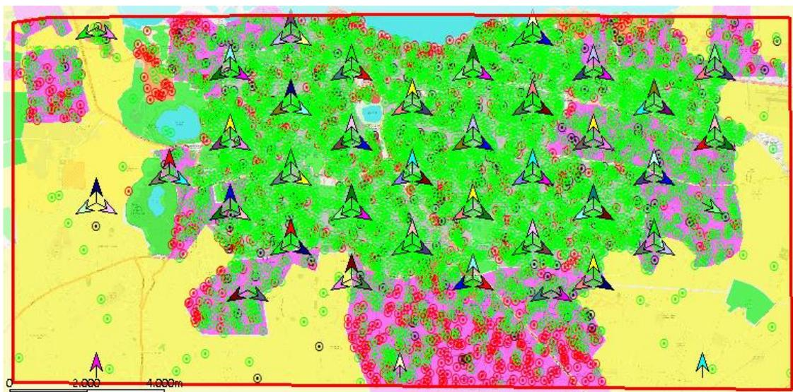
**Ilustración 162 - Simulación de usuarios para escenario LTE**
