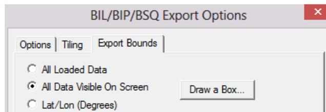
**Ilustración 43 - Configuración del área a exportar en Global Mapper**
