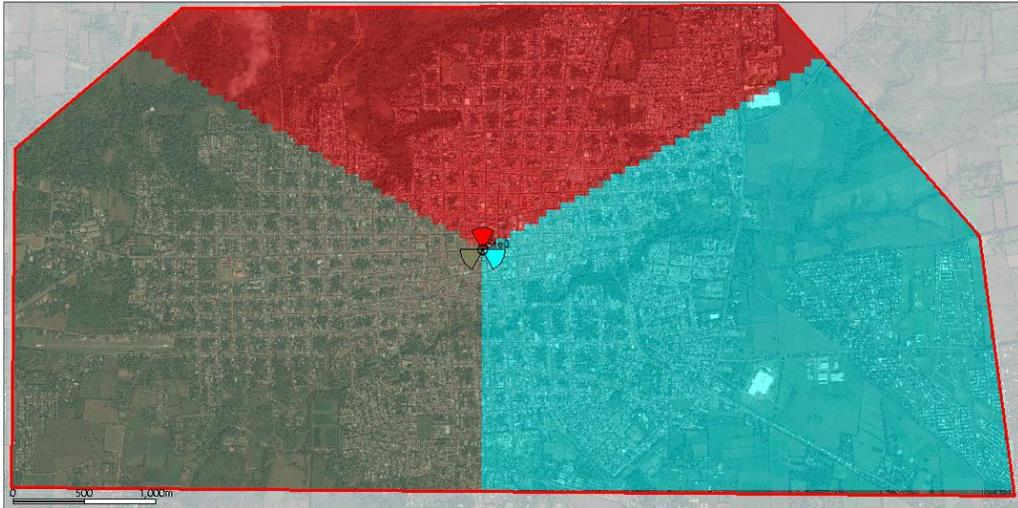
Ilustración 74 - Predicción de cobertura por transmisor
