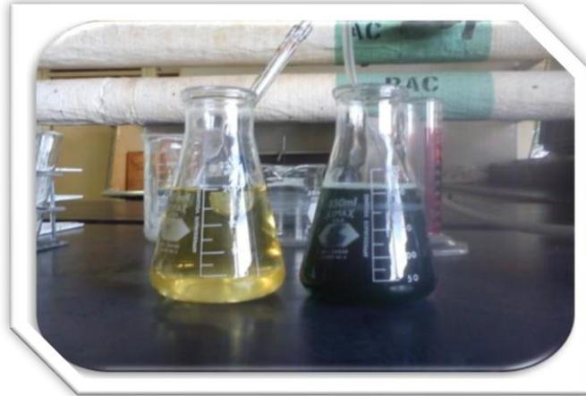
Figura # 5: Preparación de los caldos para coliformes fecales (Solución amarilla-caldo E.coli) y para coliformes totales (solución verde-caldo BVB)
