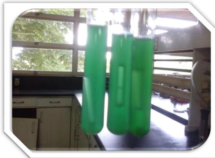
Figura # 8: Prueba confirmativa para coliformes totales con presencia de gas y turbidez dentro de la campana Durham
