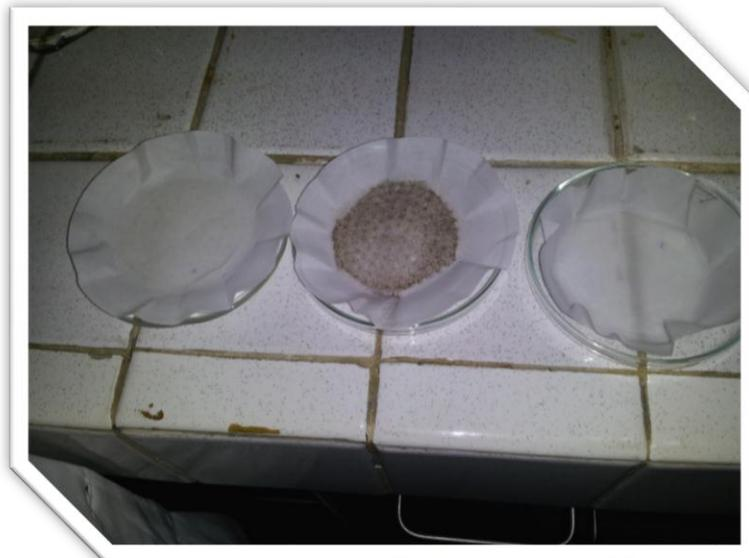
Figura # 18: Resultados obtenidos de los sólidos suspendidos de la muestra después del secado
