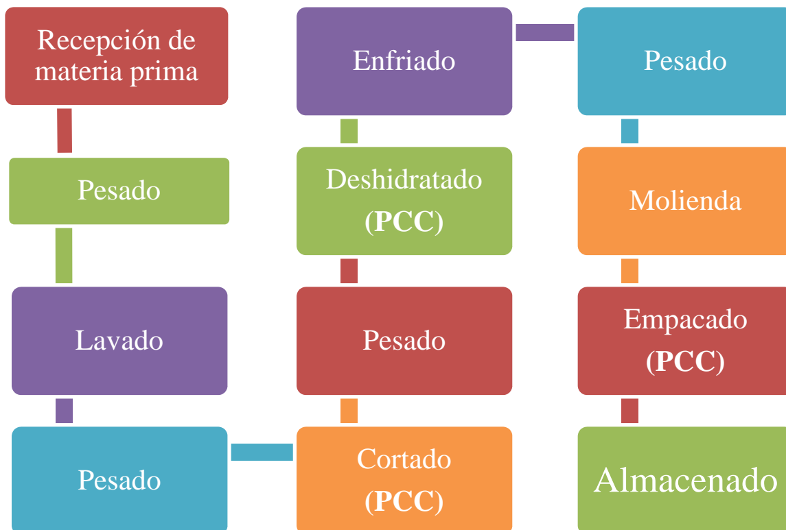
Figura N° 2. Diagrama de Procesos para el deshidratado de Jengibre.
