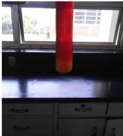
Fotografía 5. A. Comparación de 2 tubos, Rojo afirma la presencia de emodinas y el verde es el extracto etéreo de control, B. Demuestra el resultado positivo de emodinas (Coloración rojiza).
