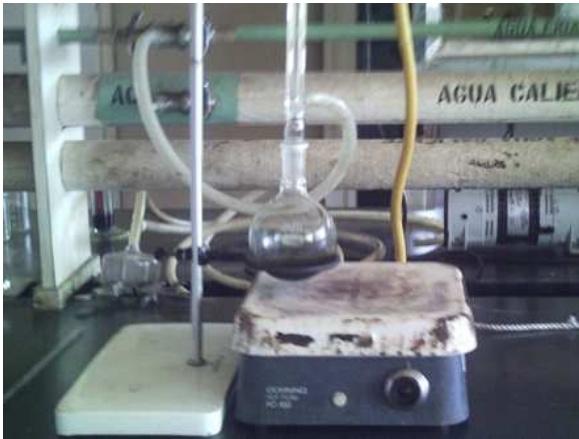
Fotografía 3. Demuestra el proceso de obtención del extracto crudo acuoso con reflujos de agua.
