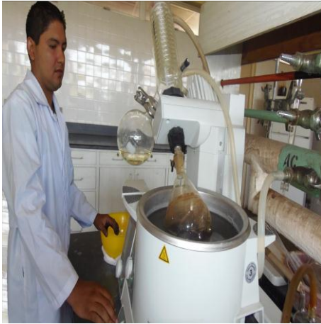
Fig. 5 Evaporación de solvente Rota vapor
