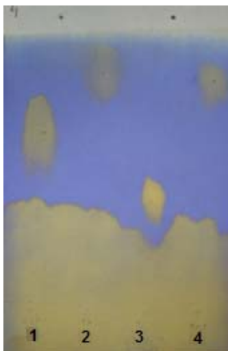
Figura V.1 Separación cromatográfica de estándares de ácidos orgánicos de 5 mg/L en papel filtro: 1 = ácido málico, 2 = ácido láctico, 3= ácido tartárico y 4 = ácido succínico.
