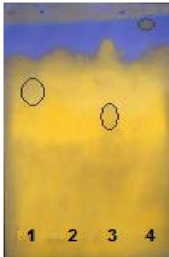
Figura V.2 Fase móvil de n-butanol, revelada con solución de azul de bromofenol, empleada en la separación cromatográfica de estándares de ácidos orgánicos de 5 mg/L en papel filtro: 1 = ácido málico, 2 = ácido láctico, 3= ácido tartárico y 4 = ácido succínico.
