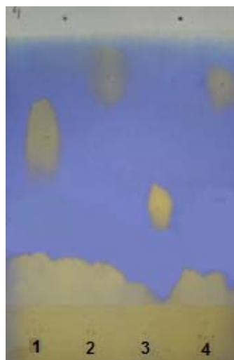
Figura V.3 Separación cromatográfica de estándares de ácidos orgánicos empleando como fase móvil una Mezcla de n-butanol conteniendo azul de bromofenol y ácido acético al 50 %.
