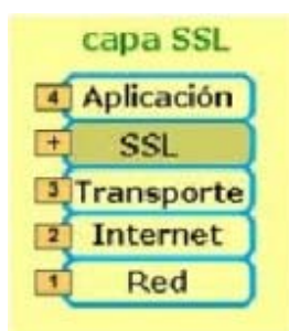
Fig. 34 Ubicación de SSL en la torre OSI
