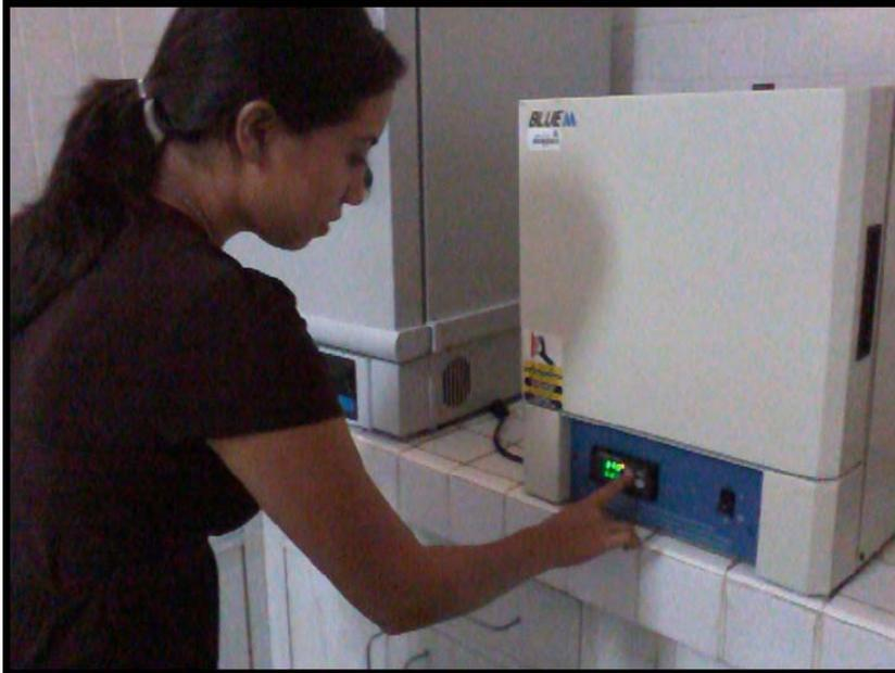
**Fig.3** Obtención de cenizas de las muestras en la Mufla.
