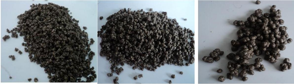
**Figura 7:**Trasformación de la harina de semilla de jícara obtenida del procesador de alimentos HORBART (Keinth & Ramírez) y molino de cuchillas Filz Mill luego del tamizado.
