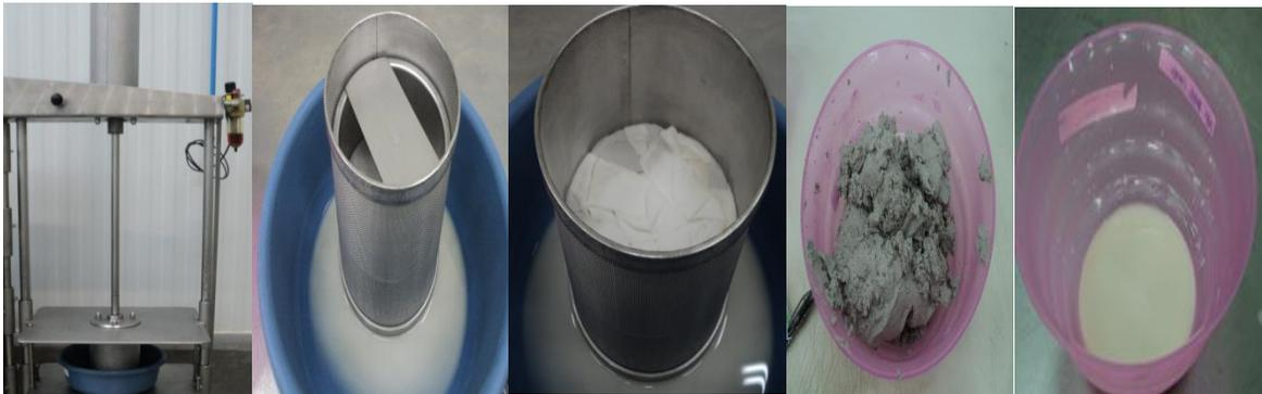
**Anexo 11: Enzimación de pasta de semilla de jícaro y medidas de viscosidad con el viscosímetro Ranges**
