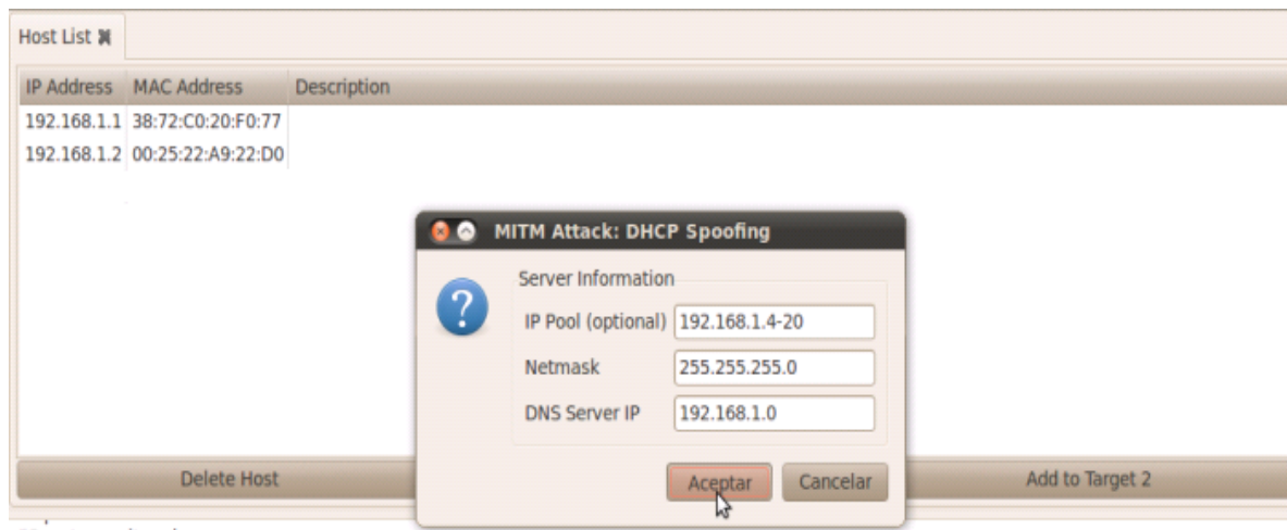
Ilustración 100: Iniciando el ataque y estableciendo el rango de direcciones Ip.
