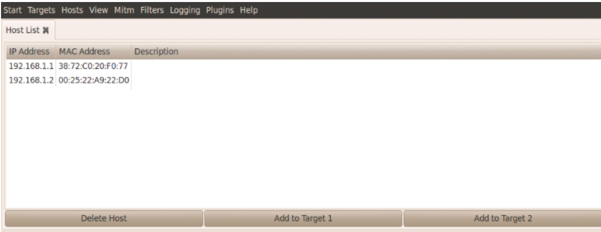
Ilustración 99: Observando las maquinas correspondientes a su dirección IP que se encuentran conectadas a las red.
