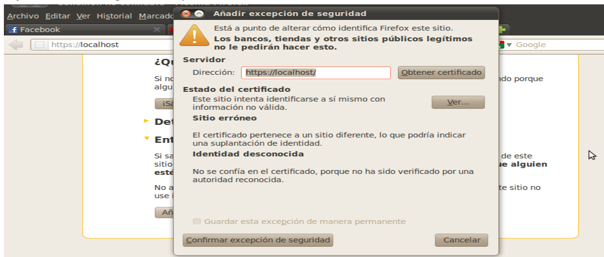
Ilustración 253: Obteniendo el certificado y confirmando la excepción de seguridad.
