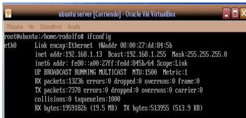
Ilustración 117: Comando Ifconfig para determinar la dirección IP.
