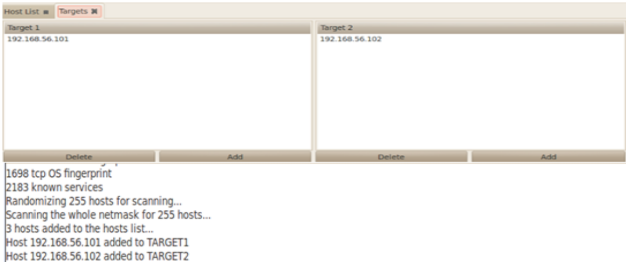
Ilustración 39: Seleccionando la dirección IP correspondiente a las máquinas que serán atacadas con la suplantación arp.
