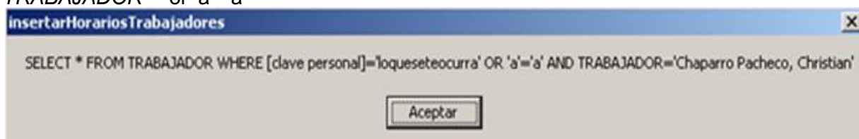
Ilustración 266: Ejecutando la sentencia con el uso de OR.
