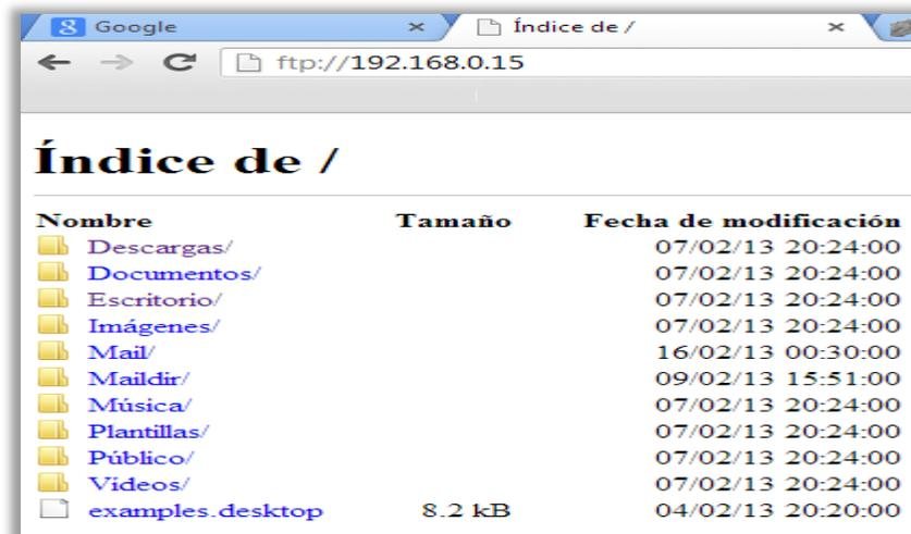
Figura 33. Comprobación de Acceso a los Archivos del Usuario mediante FTP
