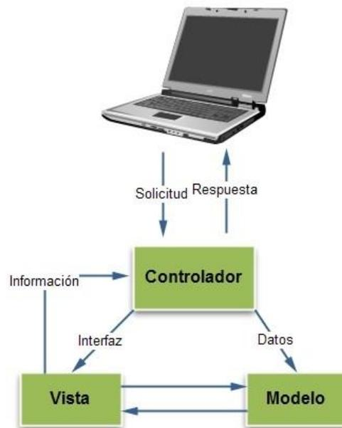
Figura 3. Esquema Modelo – Vista - Controlador
