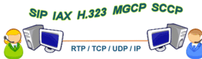
Figura 46. Protocolos de señalización
