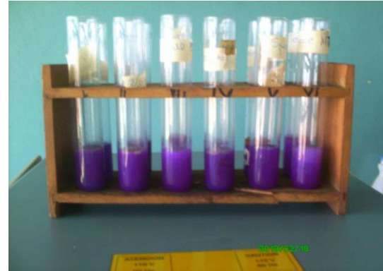
Figura 4.14 Cambios de coloración inicial y final obtenidos al realizar la prueba cualitativa a las siete muestras de queso fresco y duro aditivadas.
