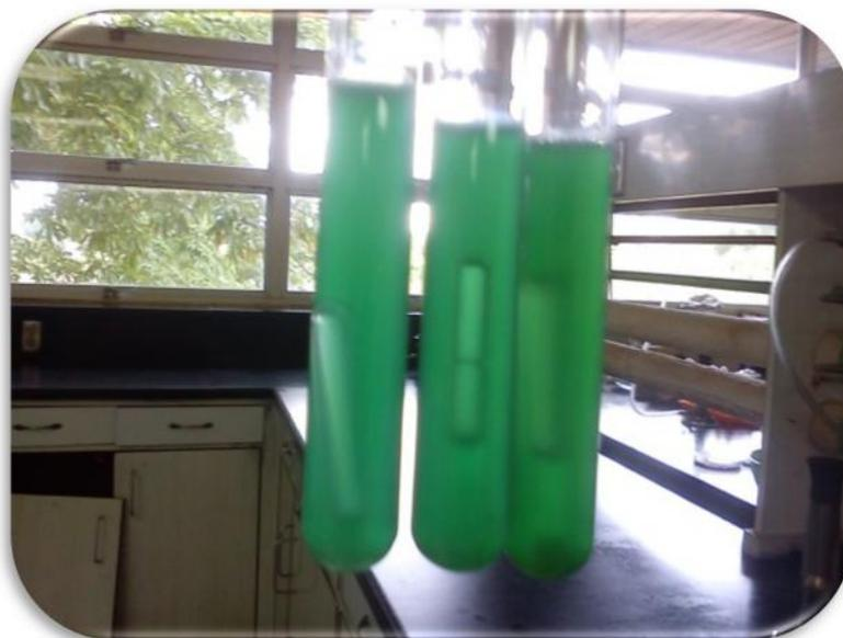
**Figura # 11.**Prueba confirmativa para coliformes totales con presencia de gas y turbidez dentro de la campana durham
