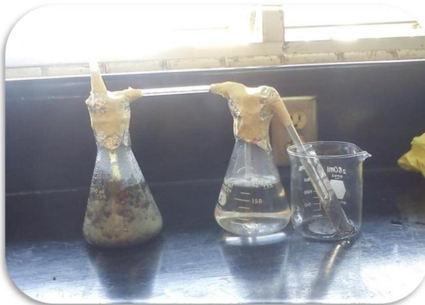
**Figura # 19.** Montaje del ensayo colorimétrico para el proceso de sulfhidración.
