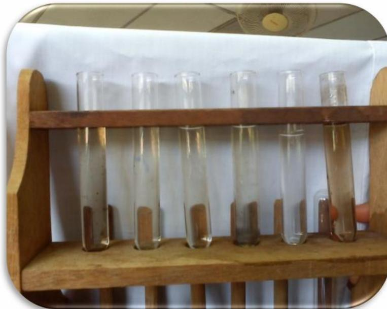
**Figura # 23.** De izquierda a derecha: solución patrón de 10ppm, 8ppm, 6ppm, 4ppm, 2ppm, 1000ppm
