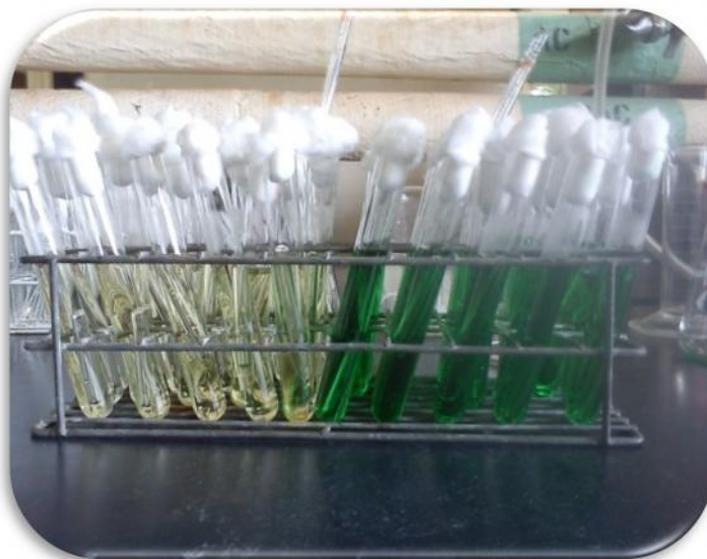
**Figura # 9.**Llenado de tubos para la prueba confirmativa para coliformes fecales
