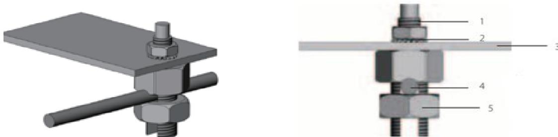
1- Perno de polarización, similar a Tyco # 2058729-1, 2- Tuerca con arandela estrella, 3- Marco de aluminio del MFV, 4- Agujero para alambre 6-12 AWG, 5- Tuerca hexagonal
