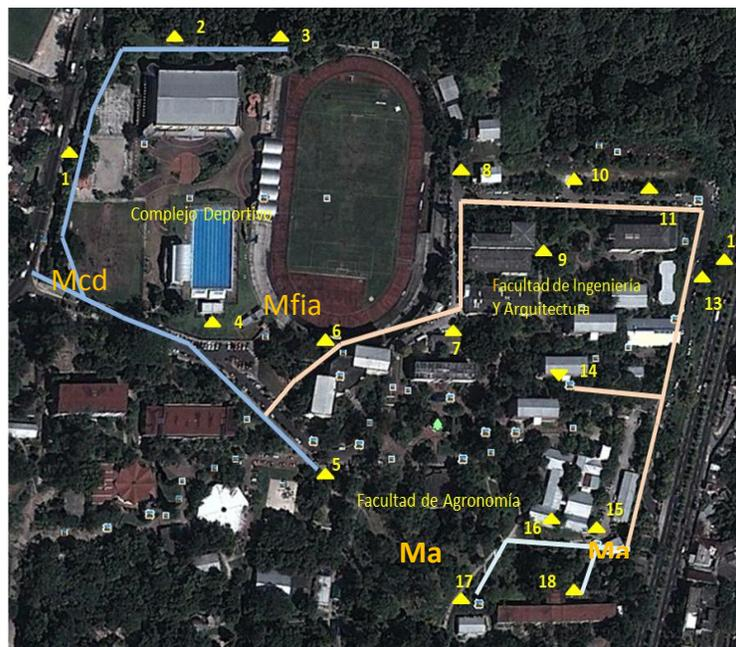
Figura 2.9-Ruta de la Acometida FIA y subestaciones existentes
