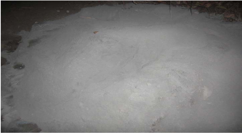
Figura 3. MEZCLA HOMOGENIZADA DE ARENA Y CEMENTO.
