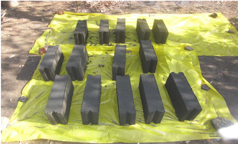
Figura 6. BLOQUES FORMADOS CON RESIDUOS PELIGROSOS QUE CONTENIAN METALES PESADOS DE Cd; Cu; Pb; As.
