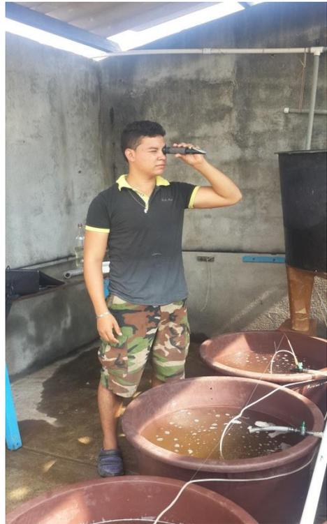
Figura 8. Medición de salinidad
