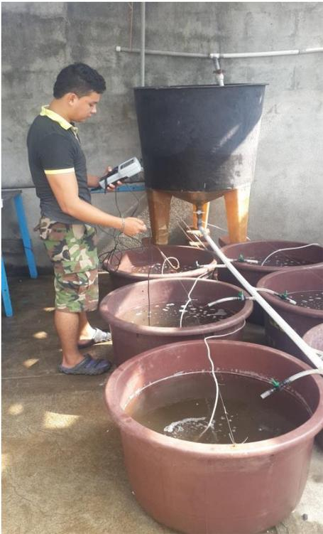
Figura 7. Medición de O.D y temperatura
