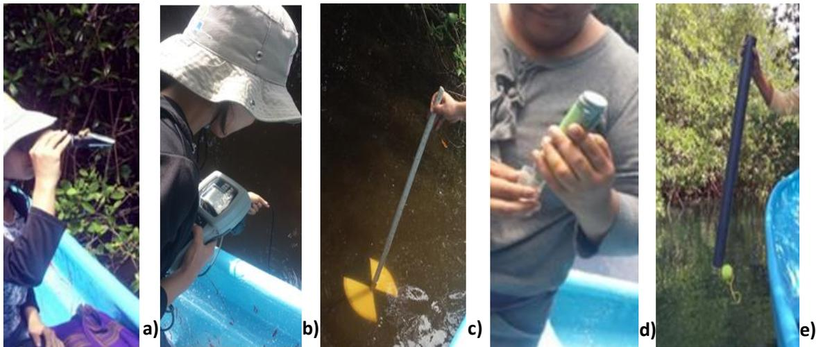
Figura 2. Medición de parámetros fisicoquímicos,. a) Medición de temperatura y oxígeno disuelto, b) Medición de salinidad, c) Medición de turbidez, d) Medición de pH, e) Toma de muestra de agua
