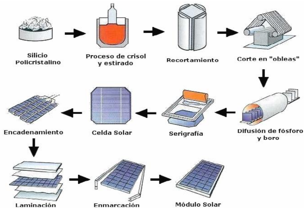
Figura 4 Proceso de fabricación del panel solar
