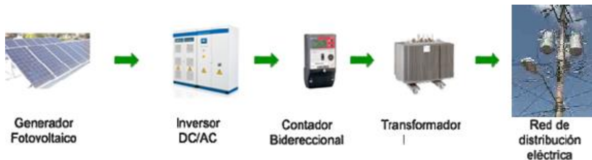
Figura 20. Esquema gráfico de los pasos de la conversión eléctrica
