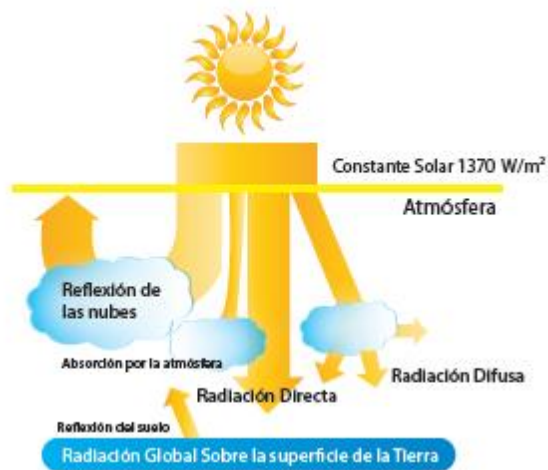
Figura 2. Influencia de la atmósfera sobre la radiación solar
