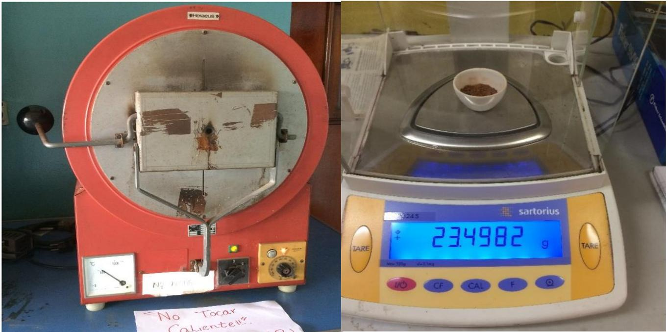
Figura 13: Calcinación y determinación de porcentaje de materia orgánica y carbonatos
