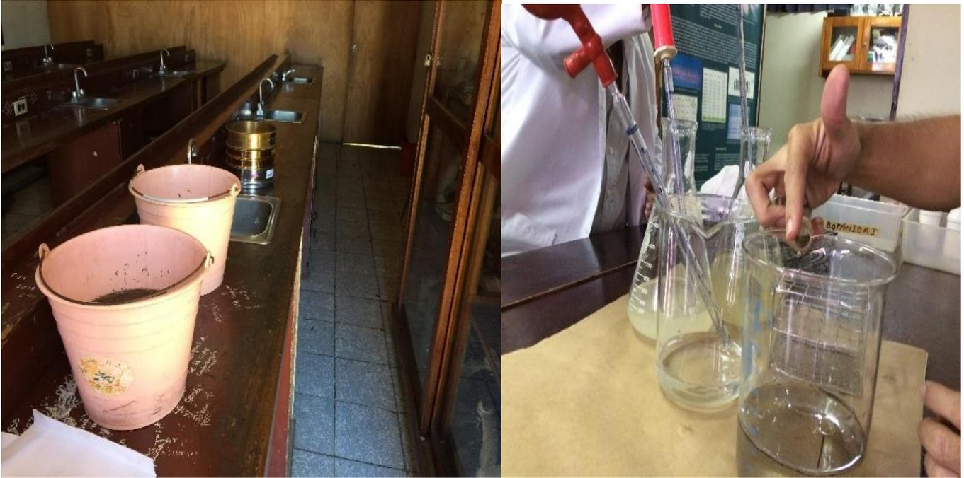
Figura 11: Extracción de esporas por el método de tamizado en húmedo y decantación
