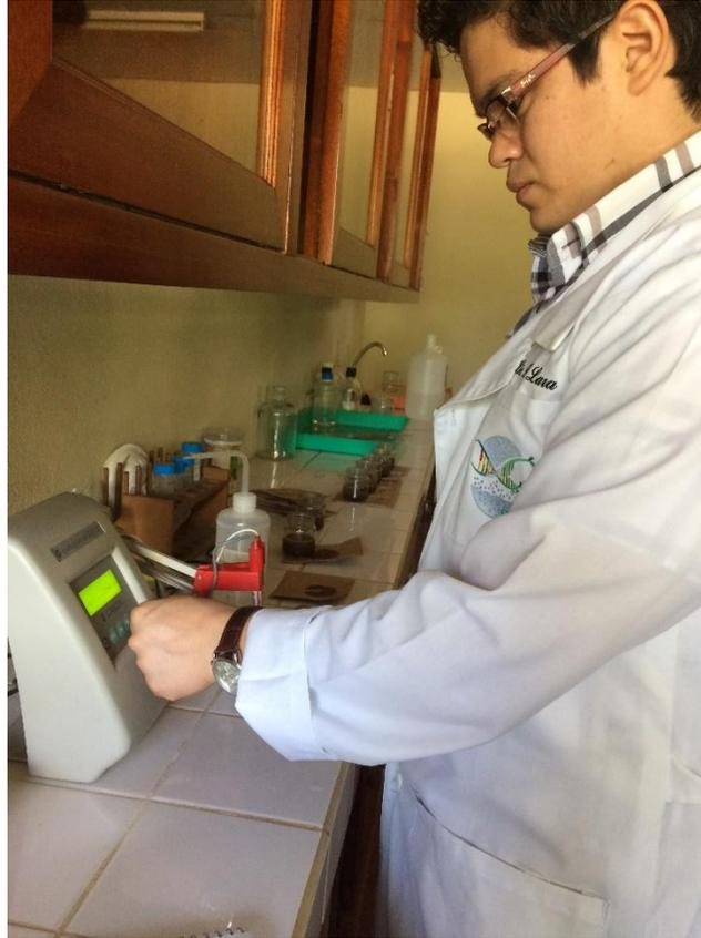
*Figura 14: Medición de niveles de pH y conductividad eléctrica*
