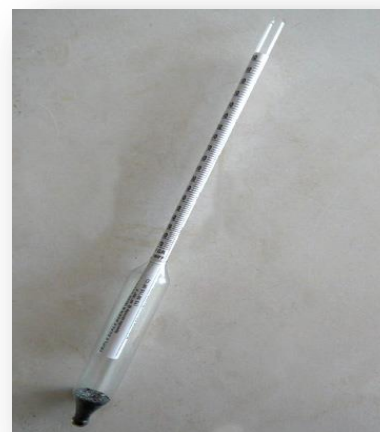
Fig.44 Alcoholímetro de Gay Lussac
