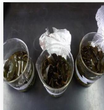
Fig 20: Extracto después de las maceraciones y antes de la filtración.
