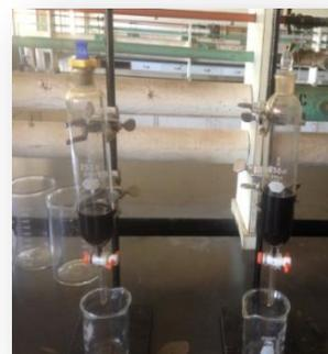
Fig 13: Separación líquido-líquido (Fraccionamiento).
