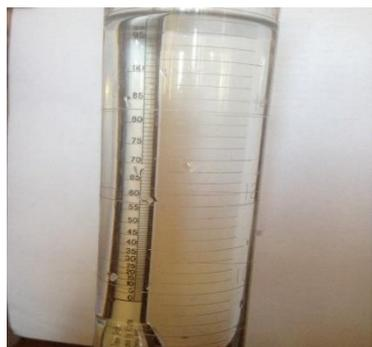
*Fig. 38: Medición del porcentaje inicial alcohol a utilizar*
