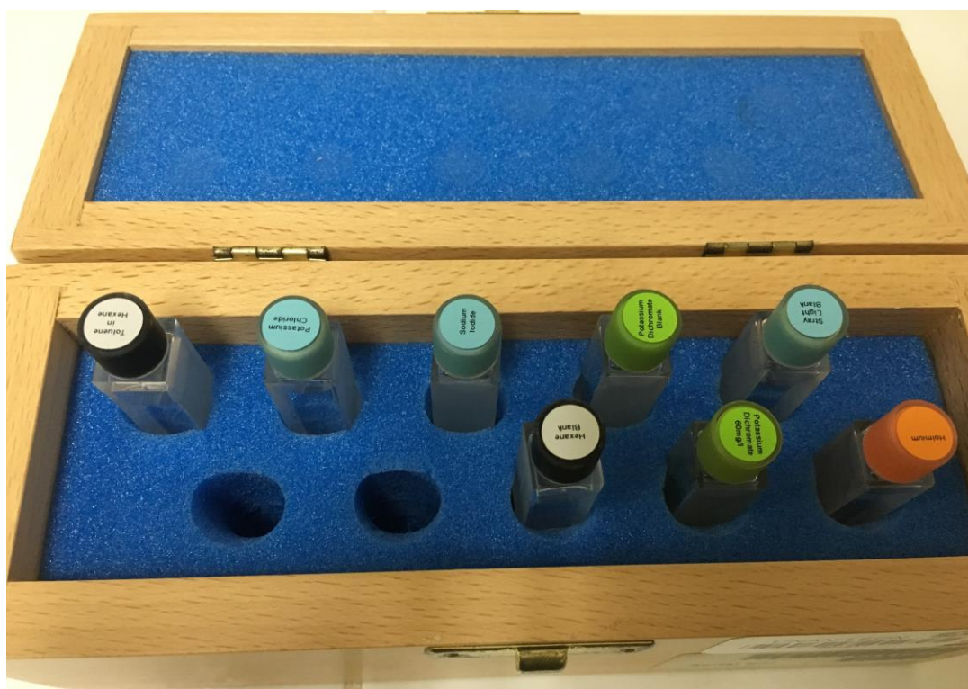
Figura 19. Material de referencia marca Starna para la verificación del espectrofotómetro UV/Vis.
