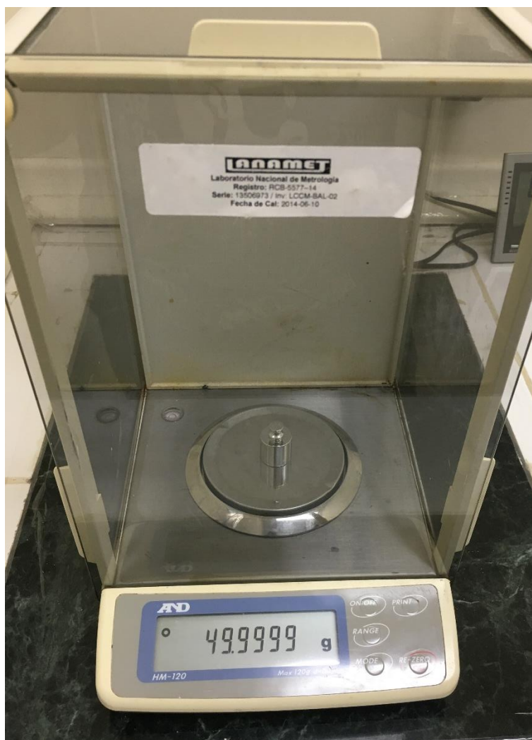
Figura 17. Verificación de la balanza A&D HM-120 con masa de 50 g.
