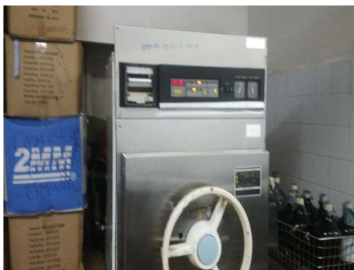
Riesgo de quemaduras y descargas eléctricas por manipulación inadecuada del autoclave
