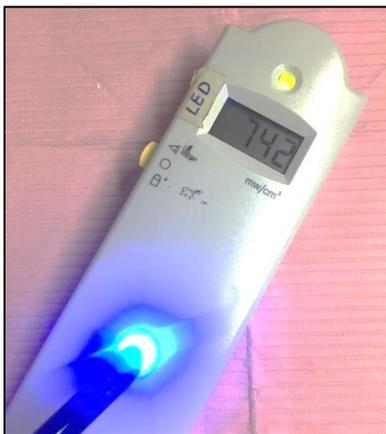
*Figura N° 1. Medición de lámpara de fotocurado led utilizando Radiómetro.*
