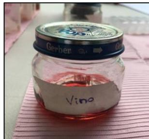
*Figura N°20. Muestra de resina compuesta sumergida en vino tinto.*
