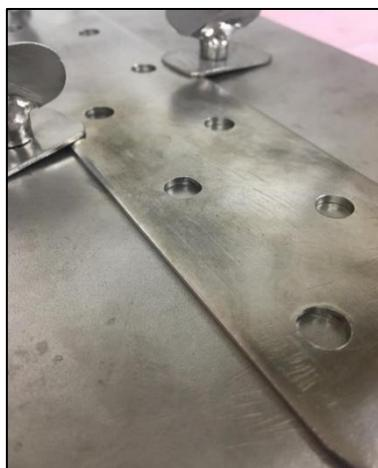
*Figura N°5. Orificios de posicionador (2mm)*
