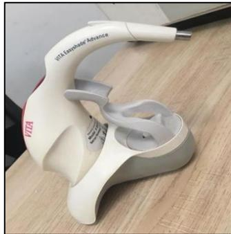
*Figura N°12. Espectrofotómetro Vita Easyshade Advance.*
