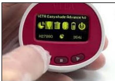
*Fig. N°14. Calibración Manual del Espectrofotómetro.*
