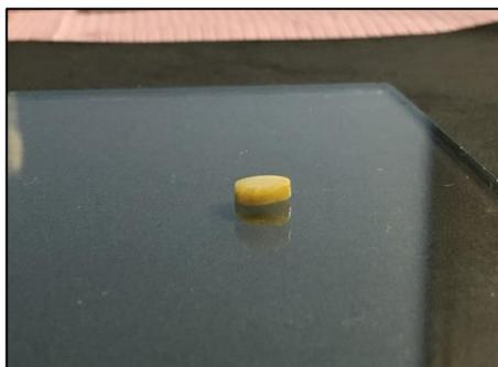
*Fig. N°17. Muestra de resina compuesta sobre loseta de vidrio lista para la medición.*
