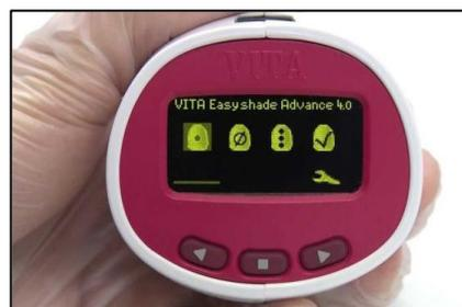
*Fig. N°15. Calibración Manual del Espectrofotómetro.*
