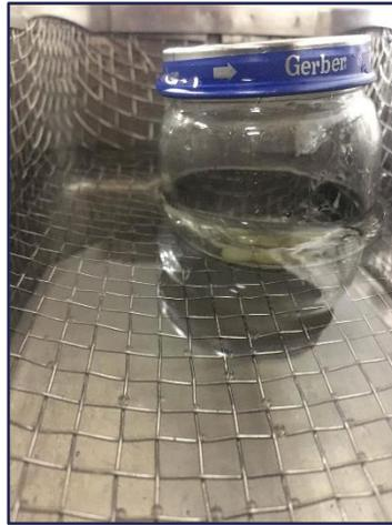
*Figura N°9. Especímenes de resina compuesta dentro de lavadora ultrasónica.*
