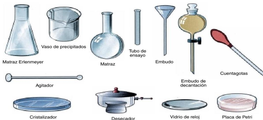
**Figura 2. Cristalería utilizada en laboratorios de enseñanza para fabricación de medicamentos.**
