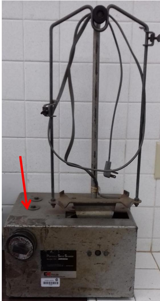
**Figura 42.** Se observa de cerca la base que se utiliza con el juego de tamices que, no está en funcionamiento por su sistema automatizado dañado.
