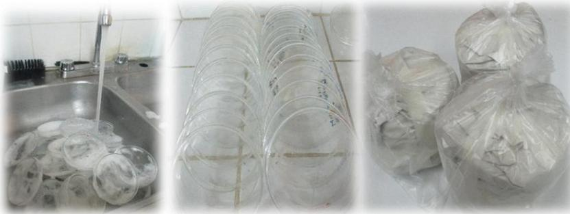
**Fig. 2:** Lavado, secado y sellado de los platos petric con papelgrafo y colocados en bolsas plasticas para su posterior esterilizacion en la autoclave (olla de presion).
