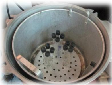
**Fig. 3:** Esterilizacion de tubos de ensayo con 10ml de agua
