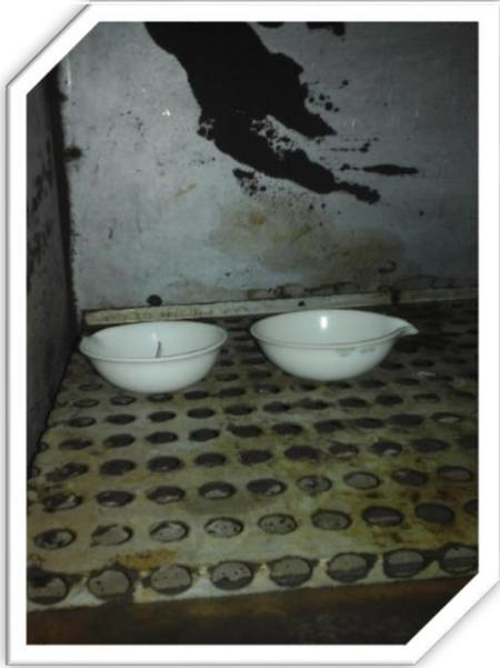
**Imagen No.17 enfriamiento de muestras Para ensayo de % de humedad.**
