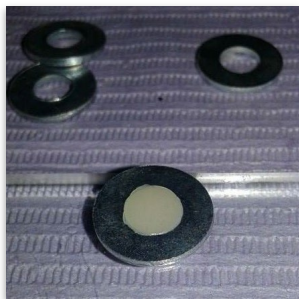
Fig.n°11 Fotografía de un disco de resina recién fotopolimerizado.
