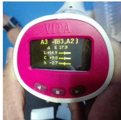
Fig. n°22 Fotografía del monitor del espectrofotómetro arrojando datos de una muestra de resina.
