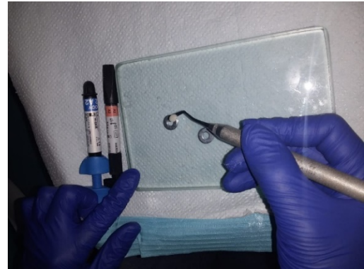
Fig. n°8 Fotografía de la realización de los discos de resina
