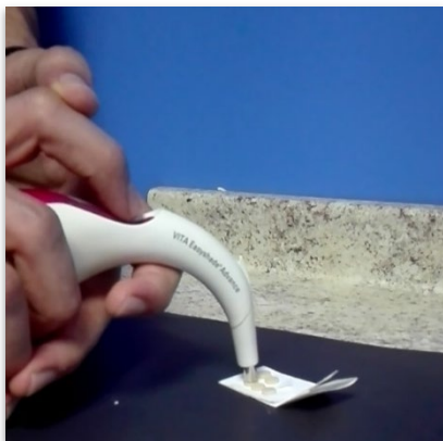
Fig. n°21 Fotografía de la toma de color de una muestra con espectrofotómetro (VITA Easyshade)
