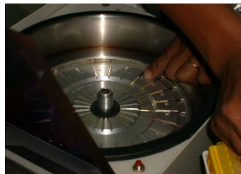
Colocación del tubo capilar en la microcentrífuga.
