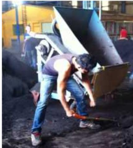
**Figura No.4. Paleo de arena verde para ser molida y mezclada.**
