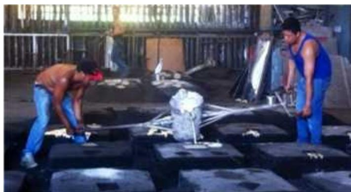
**Figura No. 6. Vaciado de aluminio fundido en moldes de arena verde. (66.5kg)**
